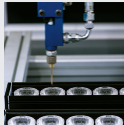
Siliconatura del diffusore Siliconing of the diffuser
